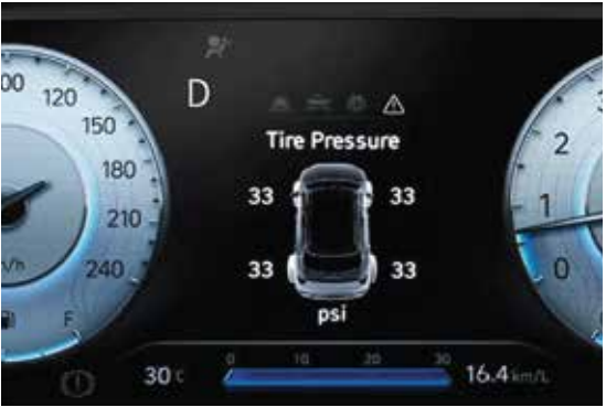
Hệ thống cảm biến áp suất lốp
