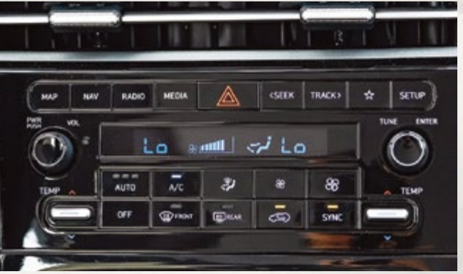
Điều hòa tự động
